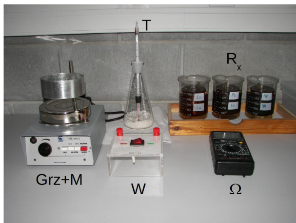
Rys. 4. Zestaw przyrządów potrzebnych do pomiaru współczynnika temperaturowego oporu metali: R_x - badany przewodnik metalowy (tu: drut w cewce) zanurzony w kąpeli olejowej w zlewce, Grz+M – urządzenie z grzałką i mieszadłem magnetycznym, W – wyłącznik, \Omega – omomierz, T – termometr do pomiaru temperatury oleju.
