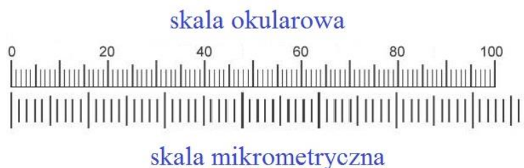
Rys. 6. Przykład widoku dwóch skal pod mikroskopem.
