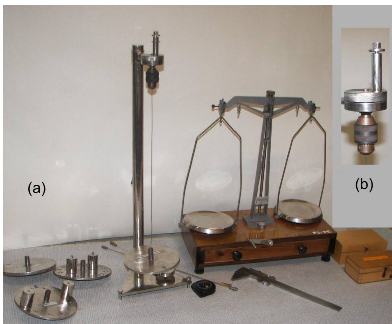
Rys. 2. a) Wygląd układu pomiarowego z przyrządami potrzebnymi do pomiaru: suwmiarka, waga szalkowa z odważnikami, stoper. b) W powiększeniu widoczny jest uchwyt do montowania pręta oraz mechanizm (na górze obracająca się tarcza z bolcem, dolna część to tarcza z otworem blokującym) do nadawania bryle początkowego skreńcenia o określony kąt.
