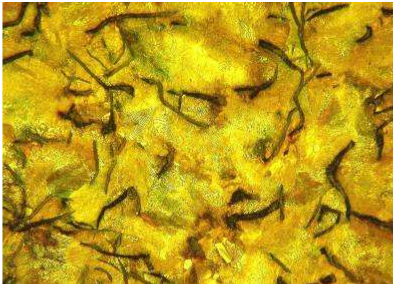
Rys. 6.5. Żeliwo szare perlityczne. Na tle perlitu widoczne ciemne płatko- we wydzielienia grafitu. Trawiono 3% nitalem. Pow. 150×
