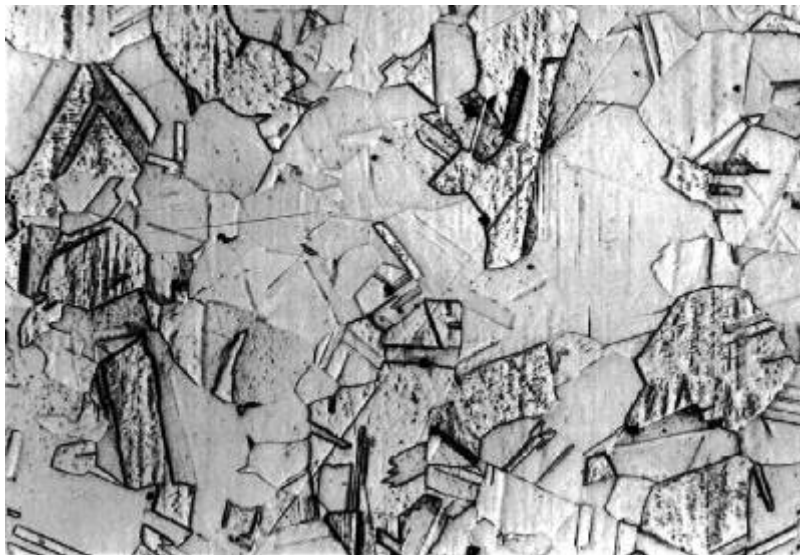
Rys. 9.26. Stop kobaltu Co-19Ni-20Cr-Nb (patent 150 030, Politechnika Lubelska) na implanty chirurgiczne. Stan po kuciu na gorąco. Osnowa stopu jednofazowa, roztwór \beta -Co. Ziarna osnowy z bliźniakami. Traw. wodą królewską (3 cz. HCl+1cz. HNO 3 ). Pow. 375x
