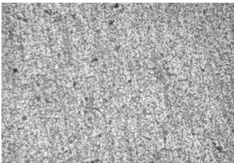
Rys. 9.15. Struktura stopu aluminium PA10, znak \text{AlSi1MgCu} , po utwardzaniu wydzieleniowym. Wydzielenia fazy \text{CuAl}_2 i \text{Mg}_2\text{Si} w roztworze stałym \alpha . Trawiono 1% roztworem HF. Pow. 300x
