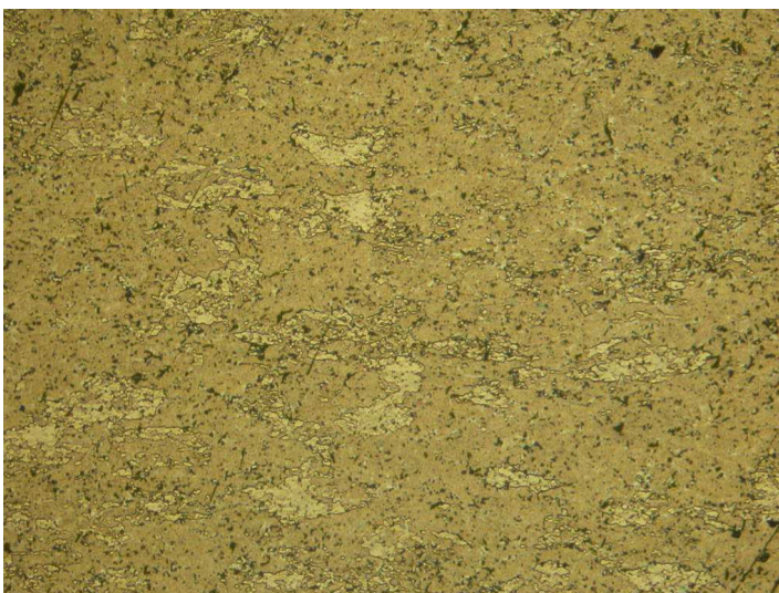
Rys. 2.9. Struktura stopu aluminium PA31, znak AlCu2SiMgMn. Wydzielenia faz Al_2Cu , Mg_2Si , Al_6Mn w roztworze stałym \alpha . Trawiono 1% roztworem HF. Pow. 63x
