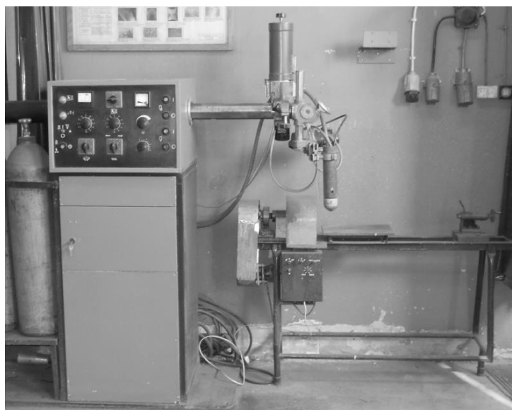
Rys.3. Urządzenie do napawania plazmowego NP1-250 z obrotnikiem.
