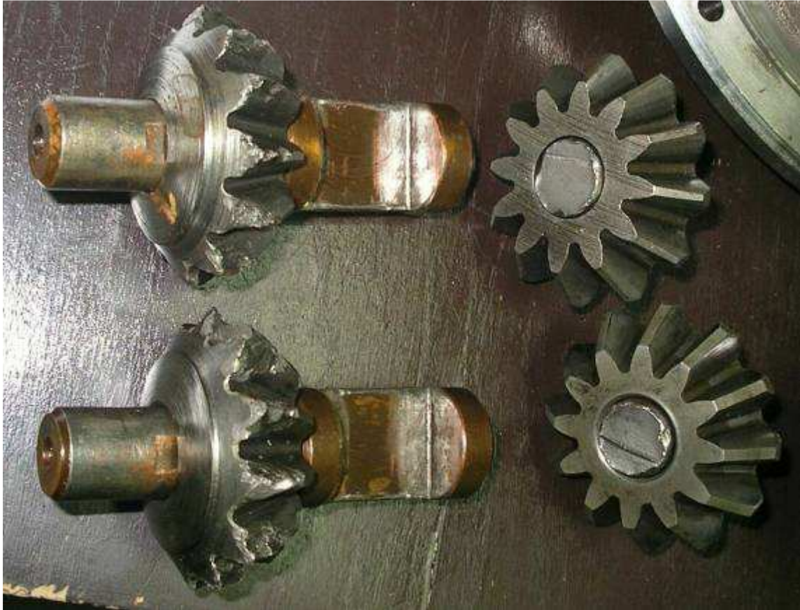
Pęknięcia zmęczeniowe osi satelitów mechanizmu różnicowego (Bizon Super), powstałe w miejscach karbu geometrycznego.
