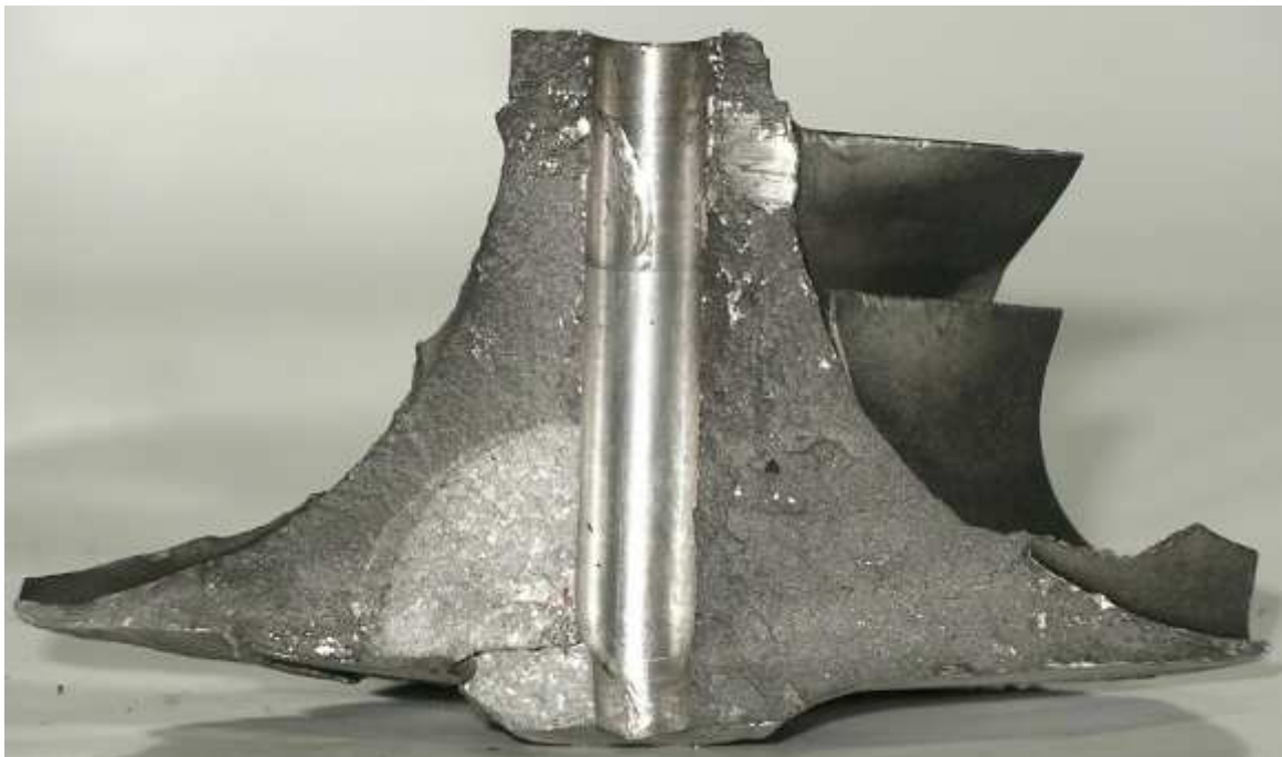
Rozerwany na skutek zmęczenia wirnik sprężarki doładowującej wykonany ze stopu aluminium (Renault Magnum). Strefa zmęczeniowa na lewo od otworu wałka.
