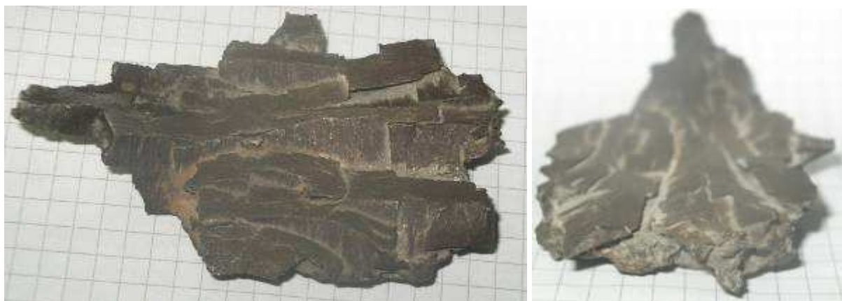
Odłamek korpusu artyleryjskiego pocisku odłamkowo-burzącego. Wielokrotne przełomy doraźne w płaszczyznach największych naprężeń tnących skorupy.
