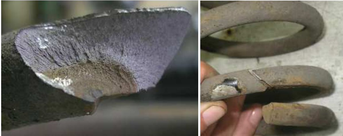
Przełom zmęczeniowy sprężyny zawieszenia oraz wyjaśnienie jego zainicjowania w postaci karbu „wybitego” przez koniec pręta sprężyny.
