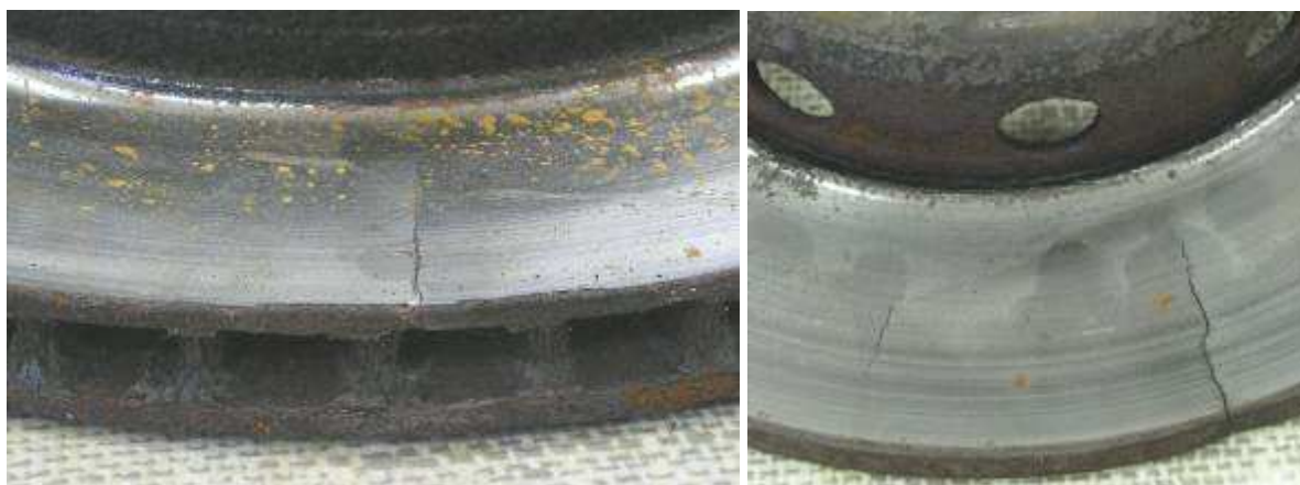
Pęknięcia cieplne wentylowanej i monolitycznej tarczy hamulcowej
