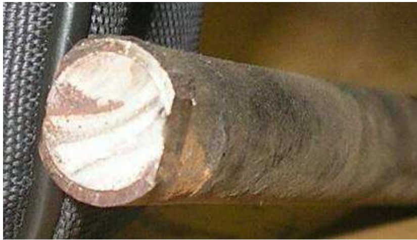
Przełom zmęczeniowy dźwigni zmiany biegów (Lublin)
