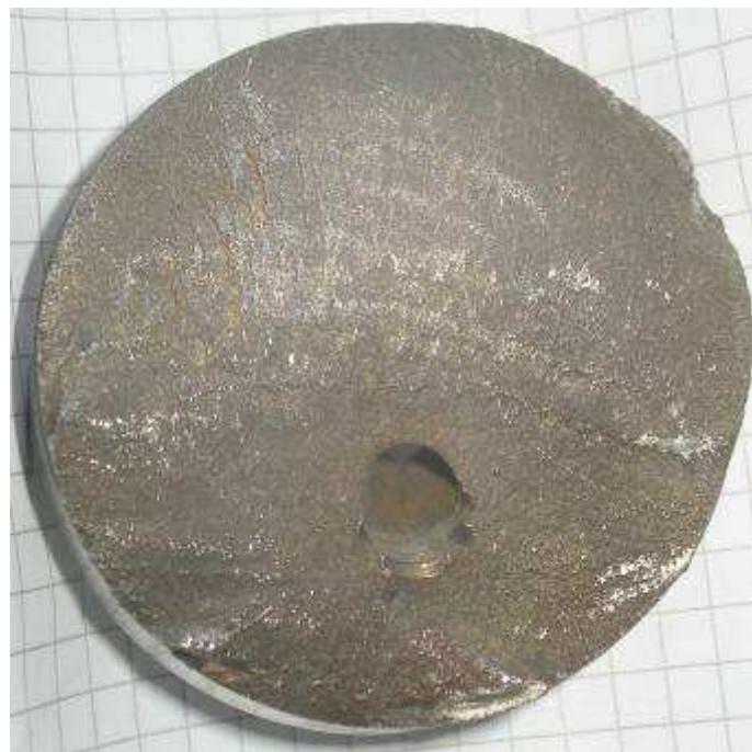
Mniej „wyraźny” przełom zmęczeniowy czopa wału korbowego wykonanego z żeliwa sferoidalnego (Ford Transit). Pęknięcie wystąpiło po naprawie wcześniej zatartego czopa przez szlifowanie na mniejszy wymiar. Wcześniejsza awaria spowodowała obniżenie twardości a tym samym wytrzymałości zmęczeniowej elementu.
