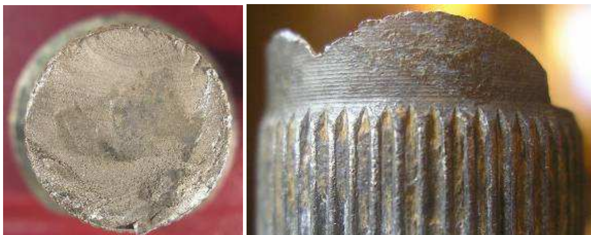
Pęknięcie zmęczeniowe końcówki drążka układu kierowniczego (Polonez Truck) w miejscu początku zaciśniętej na nim rury. Obraz przełomów charakterystyczny dla dwukierunkowego zginania.
