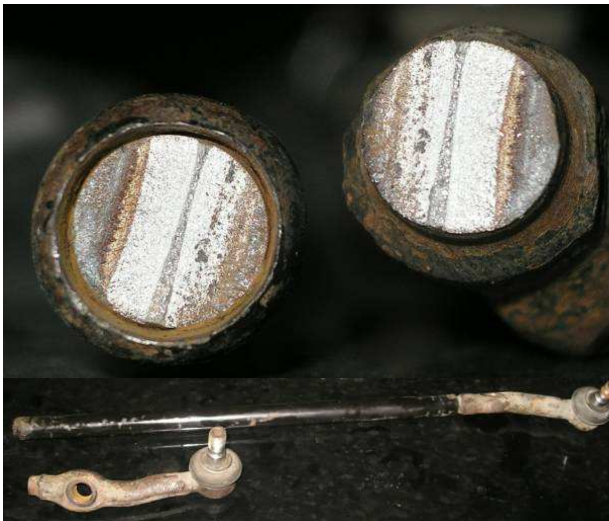
Pęknięcie zmęczeniowe końcówki drążka układu kierowniczego (Polonez Truck) w miejscu początku zaciśniętej na nim rury. Obraz przełomów charakterystyczny dla dwukierunkowego zginania.
