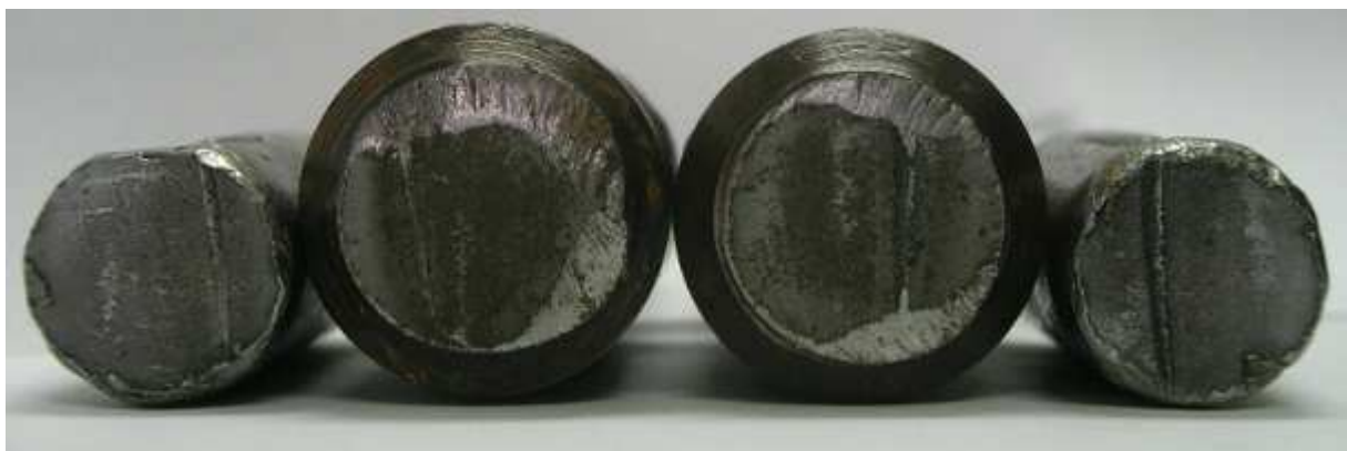
Przełom zmęczeniowy dźwigni zmiany biegów (Lublin)
