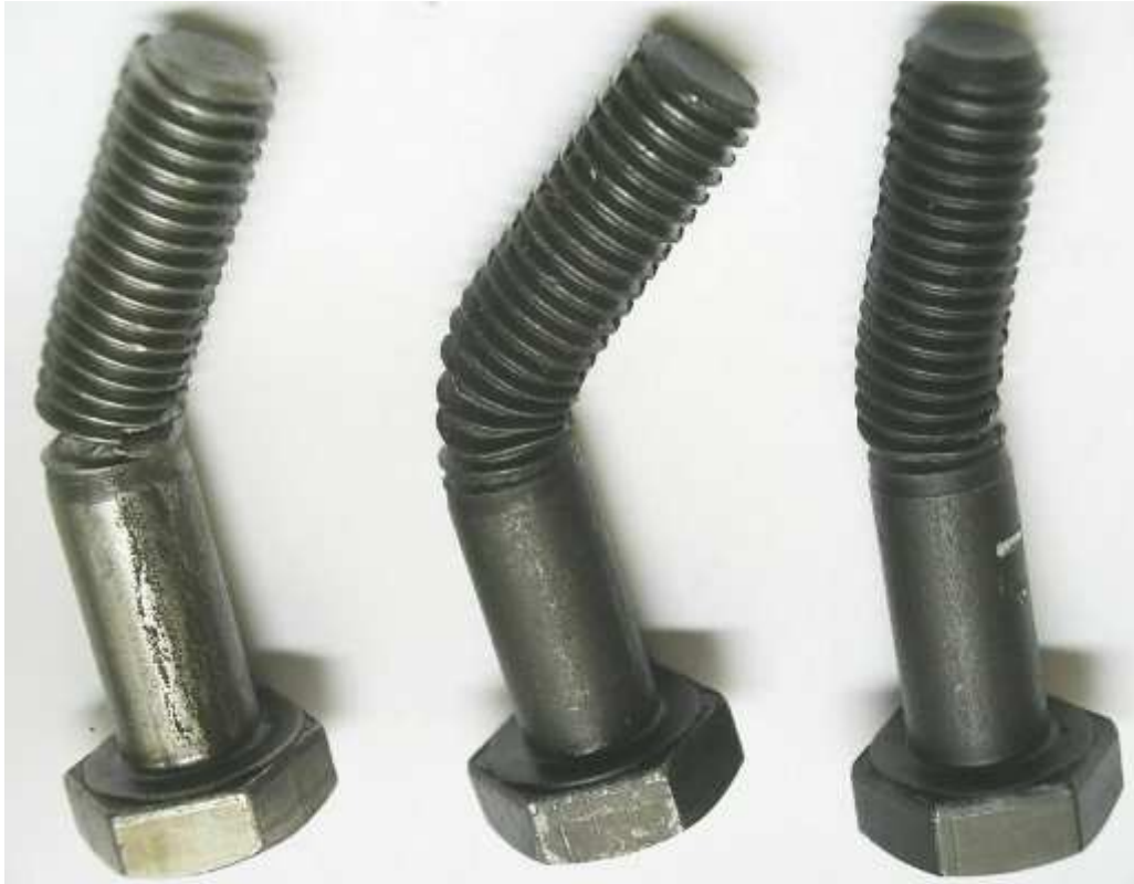
Wygląd łbów i przełomów badanych śrub M10 oraz zestawienie w celu zilustrowania kątów trwałego zgięcia, przy których śruby uległy zniszczeniu.
