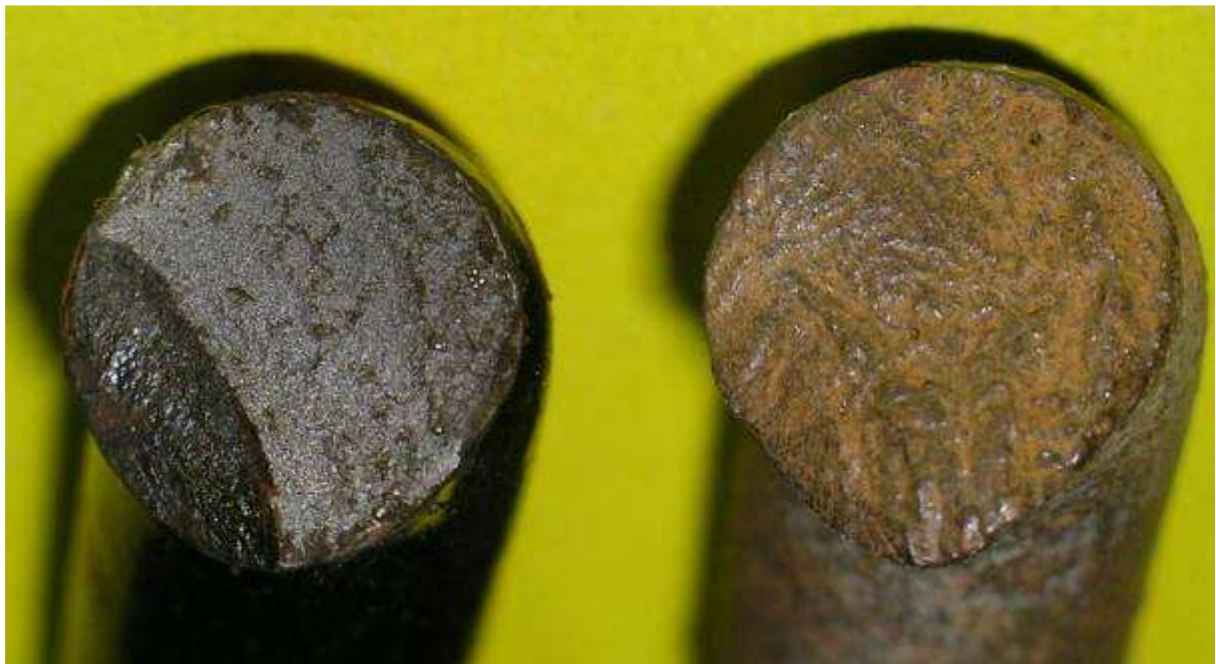
Powierzchnie dwu przełomów zmęczeniowych drążków stabilizatorów (Ford Escort). Po prawej obraz przełomu zatarty przez produkty korozji powstałe po wystąpieniu uszkodzenia.
