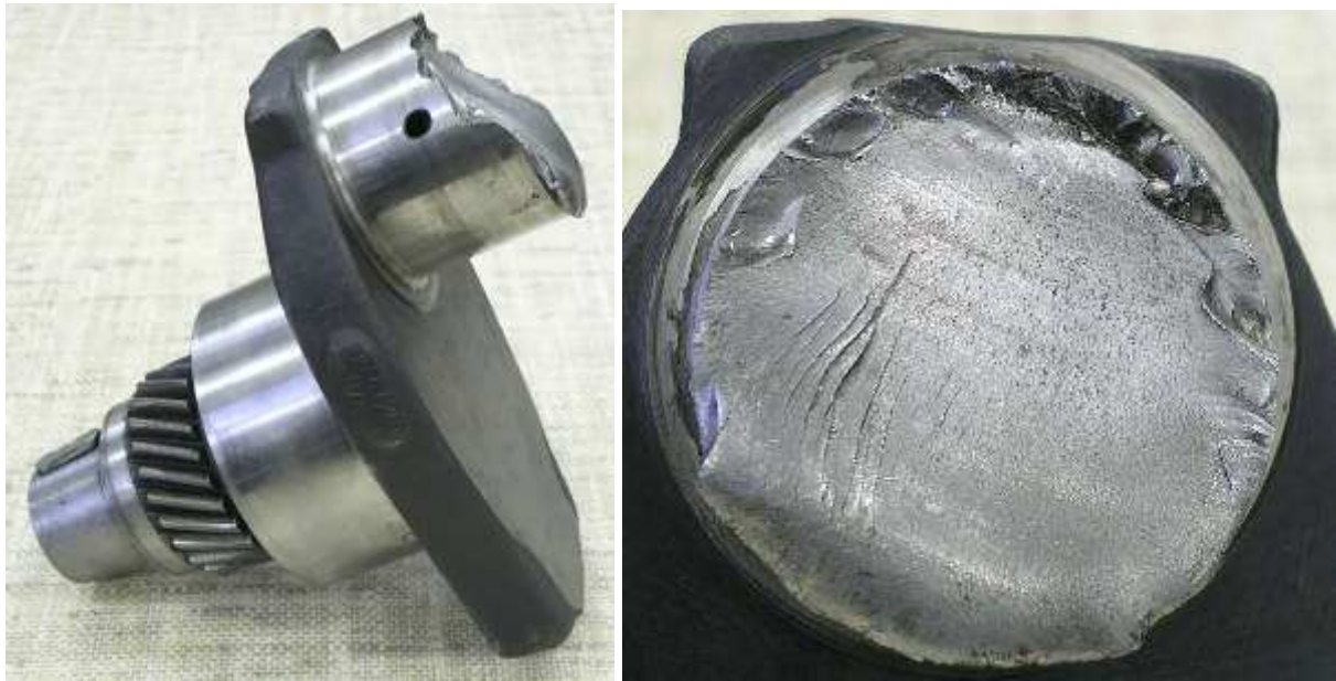
Pęknięcie zmęczeniowe pierwszego czopa korbowego kutego wału silnika (Neoplan)
