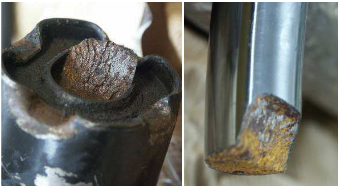
Dwie części przełomu doraźnego tłoczyska amortyzatora kolumny McPhersona (Daewoo Nubira). Przełom powstał przy pełnym wysunięciu tłoczyska w wyniku uderzenia pojazdu w drzewo. Powierzchnie obu przełomów pokryte nalotem produktów korozji powstałych po zdarzeniu.
