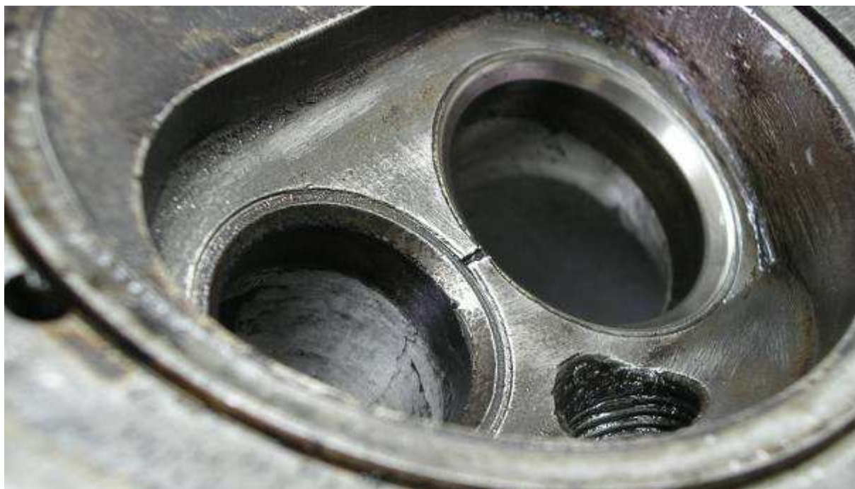
Pęknięcie mostka międzyzaworowego głowicy aluminiowej, czterosuwowego silnika iskrowego, chłodzonego powietrzem (PF 126p).
