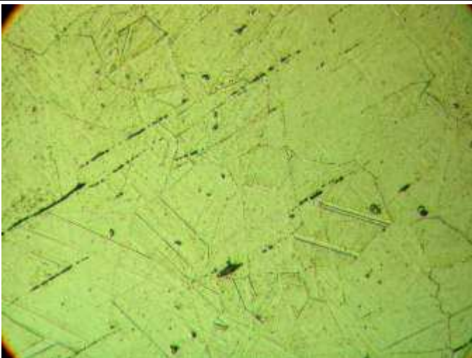
Mikrostruktura stali X10CrTi25. Widoczne jasne ziarno ferrytu z węglkami oraz pasma wtrąceń niemetalicznych. Trawiono wodą królewską, pow. 250x
