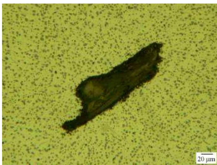
Rys. 14. Mikrostruktura kompozytu AK12/5,7Gr sq po przeprowadzonej obróbce cieplnej przesyca- nia (515°C, 6h) i sztucznego starzenia (170°C, 16h). Kompozyt o osnowie podeutektycznego stopu Al-Si zawierający 5,7% wag. cząsteczek grafitu (75-120 μm). Widoczna duża jednorodność struk- turalna, sferoidyzacja eutektyki α(Al)+β(Si) oraz faz międzymetalicznych. Eutektyka α(Al)+β(Si) oraz wydzielania faz międzymetalicznych rozmieszczone w strukturze materiału kompozytowego równomiernie. Kompozyt wykonany techniką prasowania w stanie ciekłym ( squeeze casting ). Nie- trawiono.
