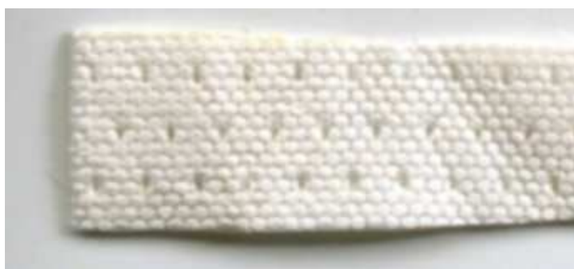
Rys. 6. Koremata, używana przy produkcji skrzydeł do szybowców.
