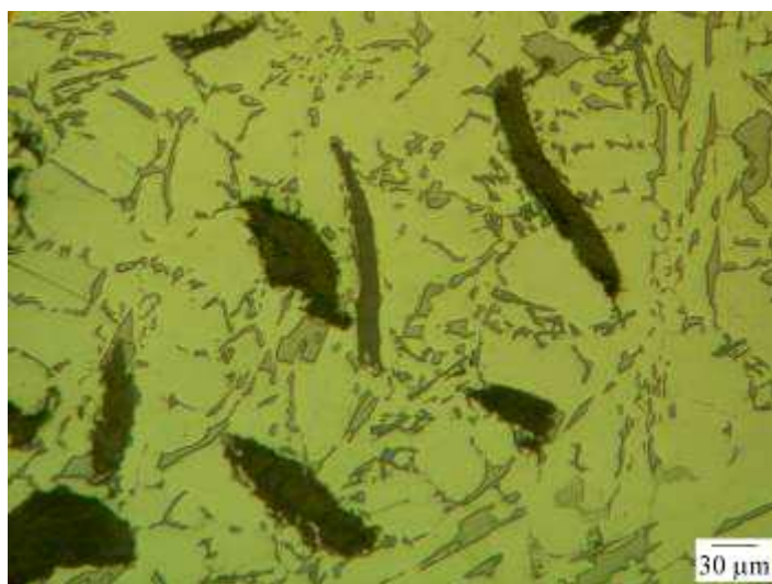
Rys. 7. Mikrostruktura kompozytu A356/5,7Gr o osnowie podeutektycznego stopu Al-Si zawierającego 5,7% wag. cząstek grafitu (75-120 \mu\text{m} ). Na tle roztworu stałego krzemu w aluminium \alpha(\text{Al}) widoczna jest iglasta eutektyka \alpha(\text{Al})+\beta(\text{Si}) , cząsteczki grafitu oraz wydzielenia fazy międzymetalicznej \text{Al}_3\text{Ni} . Kompozyt odlewany grawitacyjnie-metoda mieszania mechanicznego ( vortex ); bez obróbki cieplnej. Nietrawiono.
