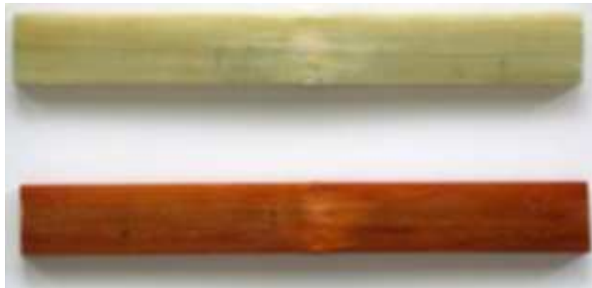
Rys. 7. Próbki rovingu po badaniu wytrzymałości na zginanie. Próbki wykonane z włókna szklanego nasączonego żywicą Epidian 5 z utwardzaczem - (a) MM (góra ), (b) Lapoxem K5 (dół).
