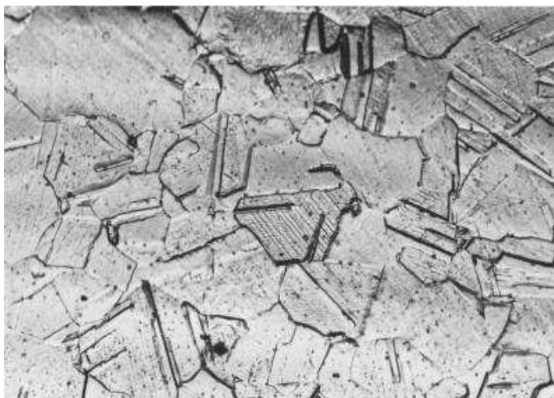
Rys.5.18. Stal odporna na korozję gatunek X6CrNiTi18-10. Widoczne równoosiowe ziarna austenitu z bliźniakami wyżarzania. Traw. wodą królewską (3 cz. \text{HCl} +1cz. \text{HNO}_3 ). Powiększenie 300x
