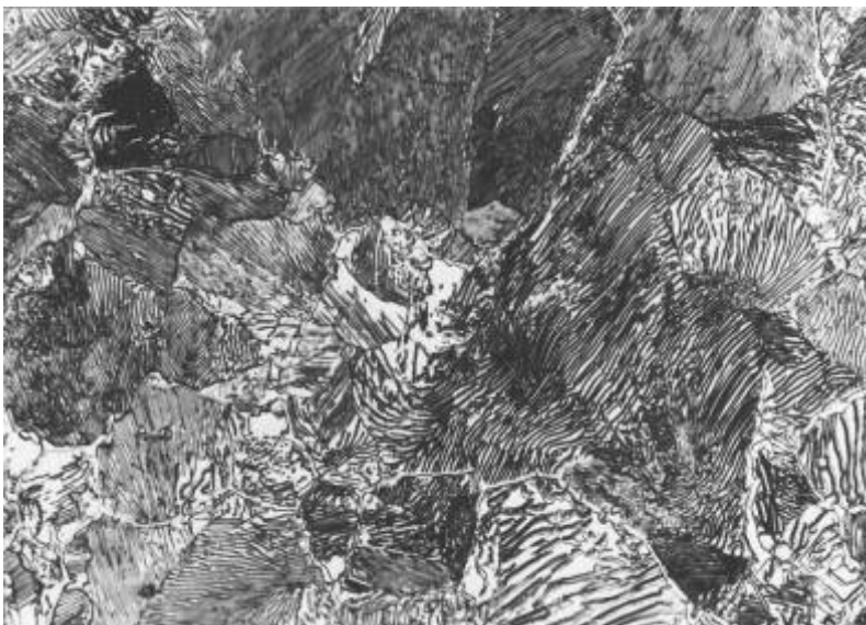
Rys.5.12. Mikrostruktura stali niestopowej narzędziowej do pracy na zimno, gatunek C80U ( C = 0,81\% ) w stanie wyżarzonym. Perli płytkowy. Trawiono 3% nitałem Powiększenie 300x
