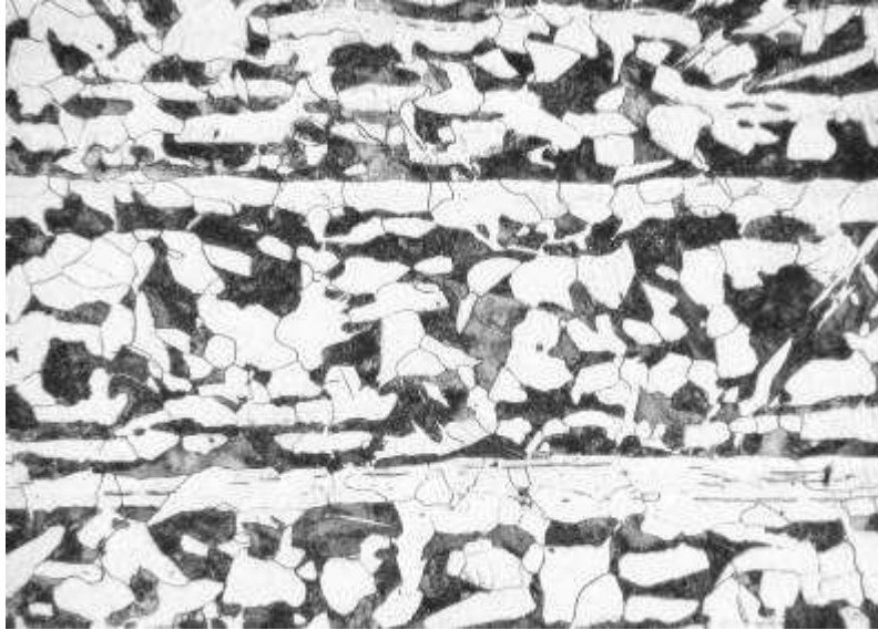
Rys.5.7. Mikrostruktura stali podeutekto- idalnej gatunek C30 po walco- waniu na gorąco. Widoczne ciemne ziarna perlitu i jasne fer- rytu ułożone pasmowo, na sku- tek zbyt niskiej temperatury wal- cowania na gorąco. Trawiono 3% nitaliem. Pow. 300×
