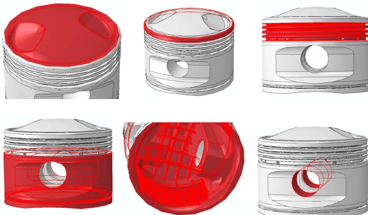
Rys.2 Termiczne warunki brzegowe modelu tłoka
