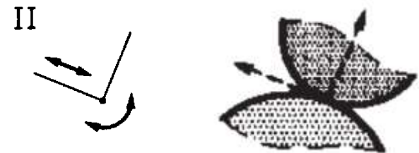
Rys. Liczba stopni swobody i schemat ideowy krzywki i popychacza [Gronowicz 2003]
