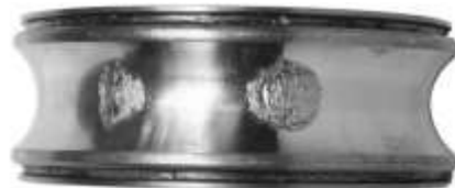
Fig. Spalling (flaking) [NSK 2011]
