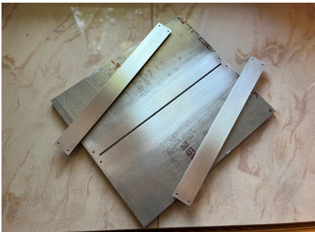
Rys. 4.12. Próbki w formie panelu przygotowane do klejenia, z widocznymi cechami technologicznymi: rowkiem oraz otworami pozycjonującymi
