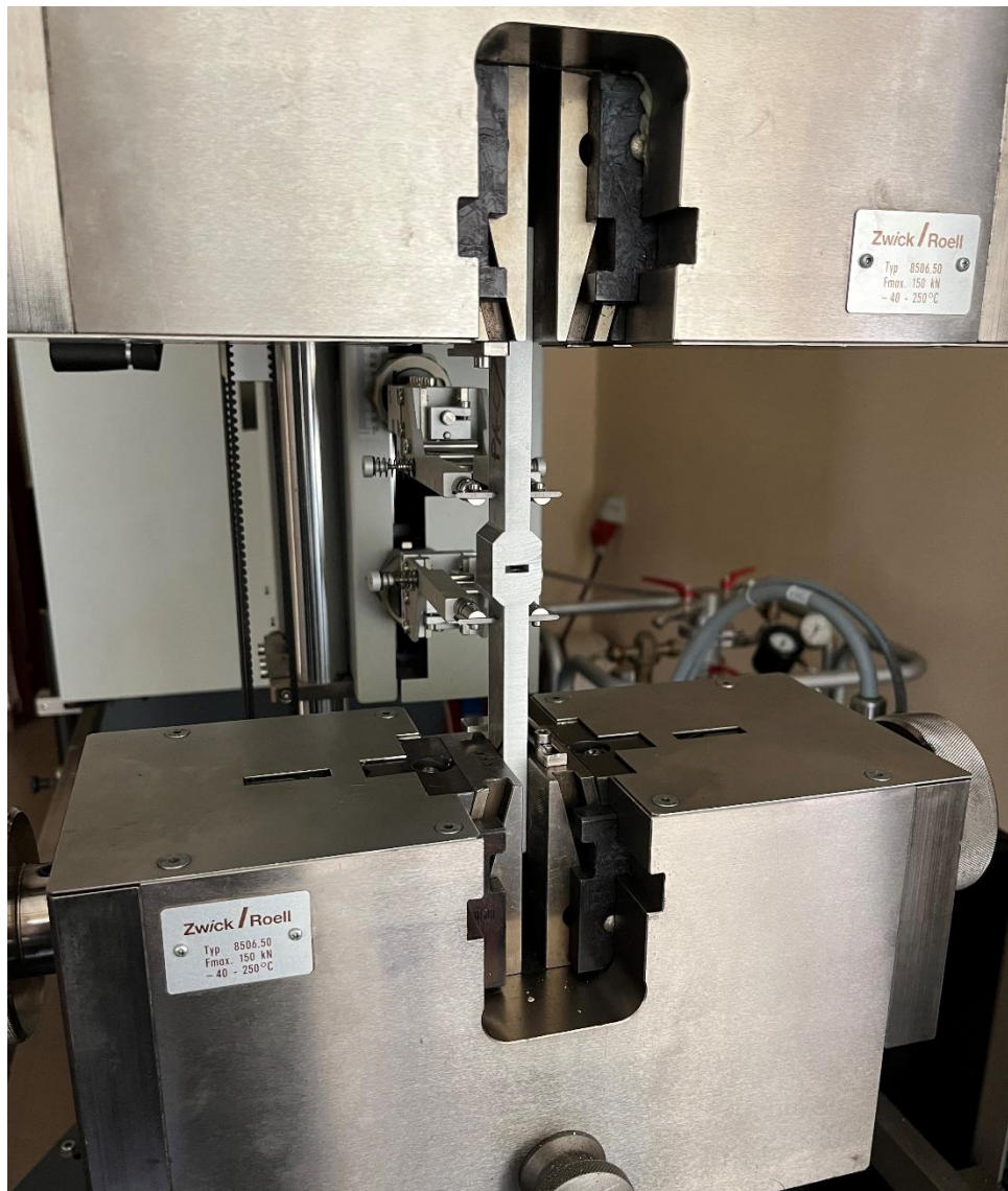
Rys. 4.14. Próbkę dwunakładkową w szczękach maszyny wytrzymałościowej z zapiętym ekstensometrem
