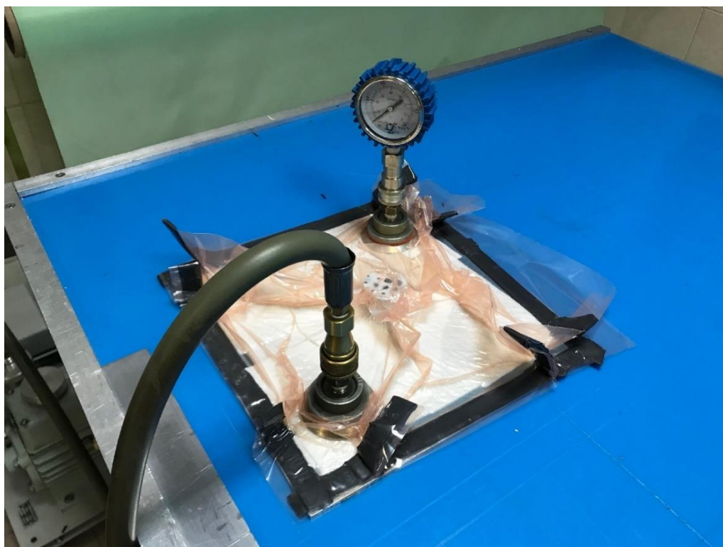
Rys. 4.6. Próbki przeznaczone do badań nanoindentacji w trakcie procesu utwardzania w worku próżniowym
