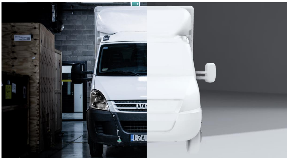
Rys. 5.4. Porównanie geometrii pojazdu referencyjnego (strona lewa) z jego cyfrowym bliźniakiem (strona prawa).
