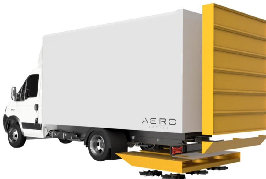
Rys. 3.1 Wizualizacja głównych przestrzeni przepływowych systemu aerodynamicznego.
