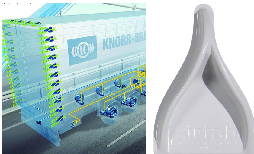
Rys. 2.22. Wizualizacja pojedynczego generatora wirów Airtab (strona prawa) oraz wizualizacja ich adaptacji na tyle naczepy (strona lewa) [83].
