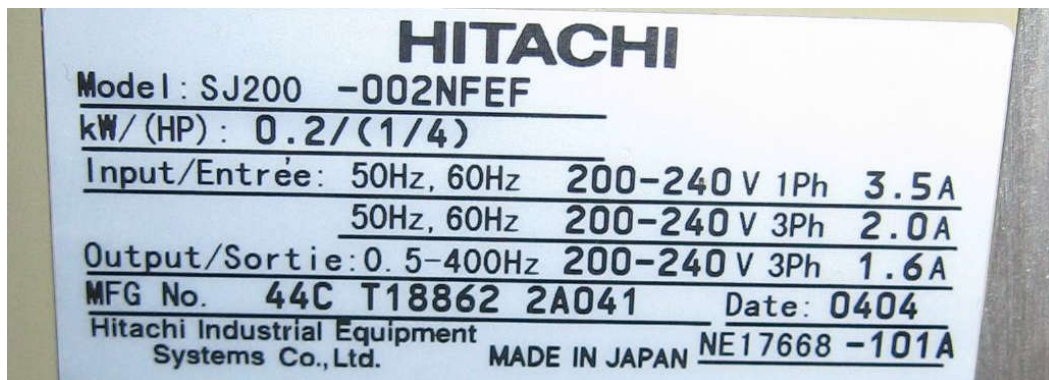
Rys. 5. Widok tabliczki znamionowej falownika.
