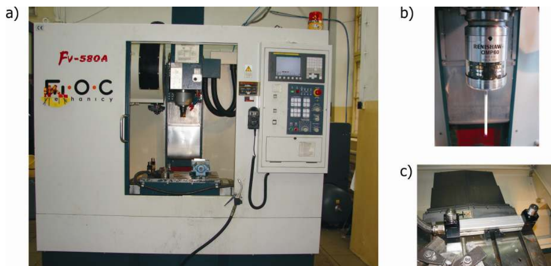
Rys. 1. 3-osiowe frezarskie pionowe centrum obróbkowe FV-580A ze sterowaniem numerycznym FANUC 0iMC i czwartą osią interpolowaną: a) obrabiarka, b) pomiarowa sonda przedmiotowa OMP60, c) pomiarowa sonda narzędziowa NC4.
