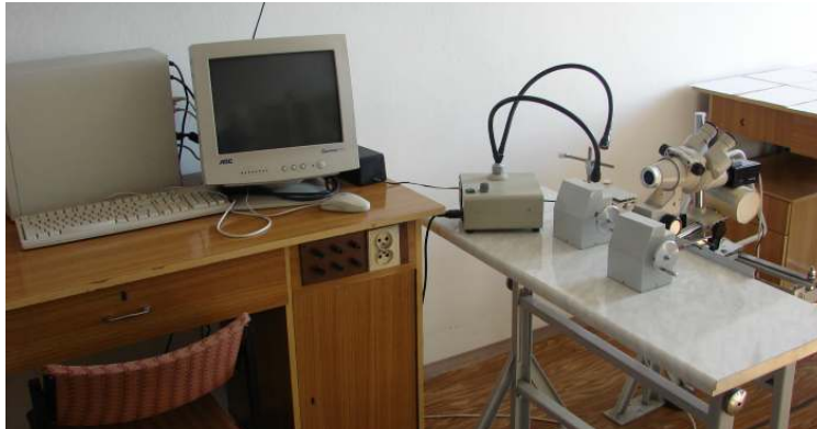
Rys. 9. Stanowisko do badań adhezyjnych (mikroskop stereoskopowy, kamera cyfrowa, zestaw komputerowy z oprogramowaniem do komputerowej analizy obrazu)
