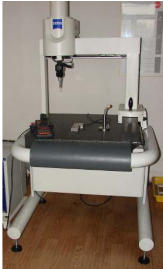
Rys. 5. Współrzędnościowa maszyna pomiarowa Vista firmy Zeiss z układem sterowania numerycznego CNC
