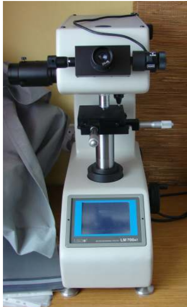
Rys. 7. Mikrotwardościomierz LM 700AT do pomiaru twardości metodą Vickersa oraz Knoop
