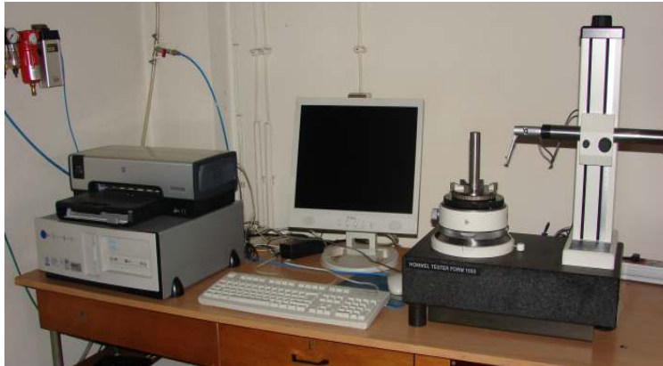
Rys. 3. Przyrząd do pomiaru błędów okrągłości HOMMEL TESTER F1000
